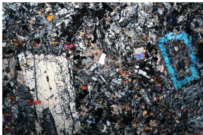
Рисунок 2. Порфировая структура кварцевого долерита. Об. 2,5 x . С ан.
