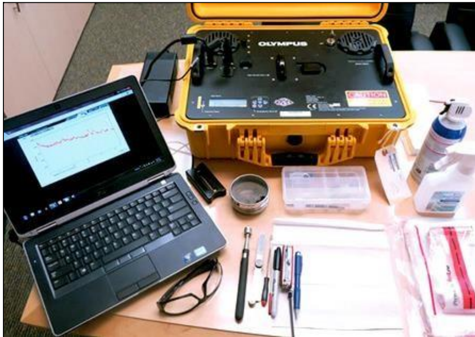
Рисунок 1. Вид рабочего места при использовании портативного дифрактометра Olympus Terra
